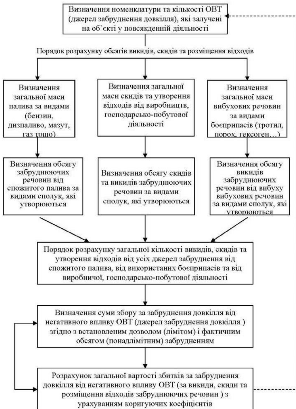
Рис. 1. Структурно-логічна схема порядку розрахунку вартості збитків від негативного впливу ОВТ на довкілля (за викиди, скиди та розміщення відходів, забруднюючих речовин)
